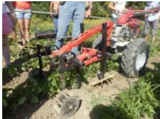
Il est possible de rajouter des éléments buteurs à l'arrière du châssis devant les roues du motoculteur pour buter/chausser les cultures. La largeur de travail est réglable en fonction des dimensions du sillon/de la planche. Et il est également possible de surélever l'outil de 10 cm en mettant des roues en fer plus grandes afin de pouvoir passer dans des cultures hautes. La profondeur de travail est également réglable pour travailler de 2 à 4 cm de profondeur.
