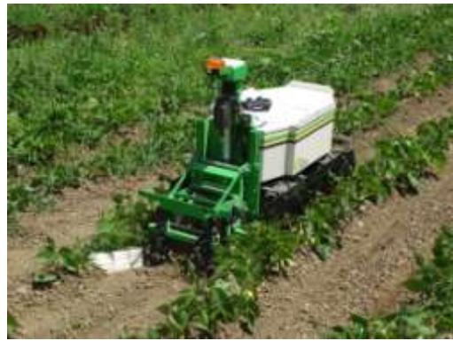
Il est nécessaire de prévoir un inter-rang de 65 cm pour faciliter le passage du robot. Le robot permet de désherber mécaniquement entre les rangs et sur le rang. Différents accessoires peuvent être positionnés : herse étrille, rasette à brosse ,bineuse à ressort.
